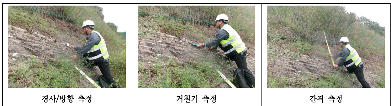
【사진 44.3.3】 불연속면 측정 현황
